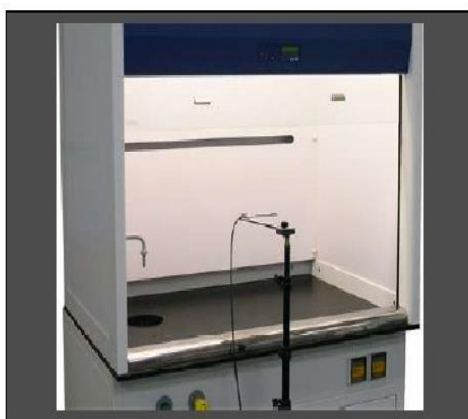
شکل ۳. تقسیم‌بندی دهانه‌ی هود به شبکه‌ای از خانه‌های مجازی (الف)، نحوه‌ی قرارگیری آنومتر روی یک سه‌پایه برای اندازه‌گیری سرعت در دهانه‌ی هود (ب)
